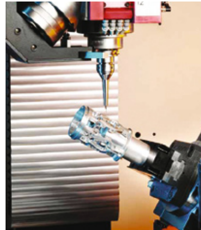
NC-Dreh-Schwenktisch für die 4- und 5-Seitenbearbeitung NC-rotary/swivelling table for 4- and 5-face simultaneous machining
