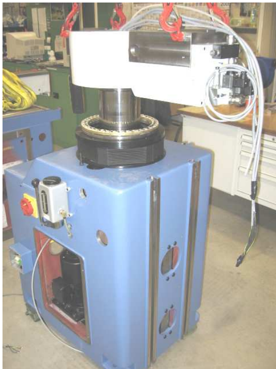
Unterbau einer Radial-Bohrmaschine
