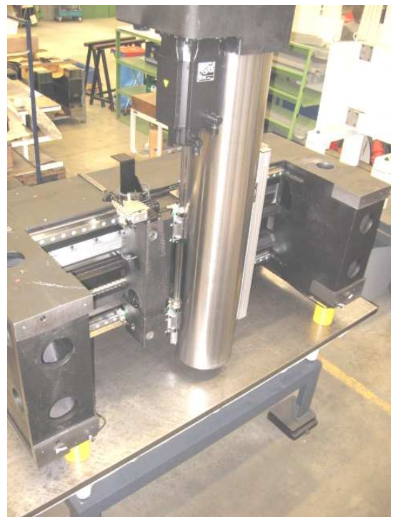
Koordinaten-Fahrwerk für Bearbeitungs- Zentrum komplett vormontiert und geometrisch geprüft
