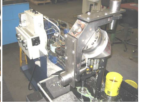
Schwenkgreifer für Werkzeugwechsler bei Endmontage auf Prüfstand
